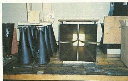
*Contoh horn antenna yang digunakan dalam Anechoic Chamber.
