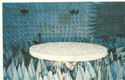
*Penyusunan makmal untuk mengukur radar cross-section.
